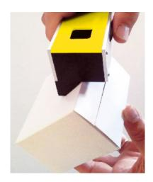
Con nuestro aparato de medición del hendido CITO CREASY usted puede comprobar los marcados de los hendidos. Nuestro aparato de medición le ayuda durante la configuración en la máquina para optimizar los hendidos y aumentar la vida útil de sus herramientas y troqueles de hendido.
