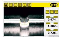
CITO CounterControl es un sistema de medición óptico y sin contacto para el control de la anchura de canales fresados en contras fenólicas (pertinax) y placas fresadas.
